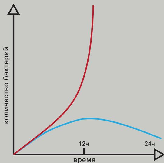
На графике слева показано сравнение снижения количества бактерий на обычном керамическом изделии и изделии с глазурью VitrA Hygiene: количество бактерий снизилось на 99,9% за 24 часа.
