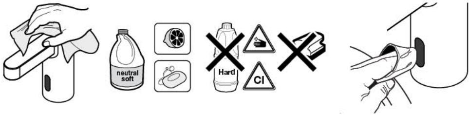
**ES** Limpiar el grifo solo con detergentes líquidos no ácidos. No utilizar ningún tipo de estropajo. Mantener limpio el visor cuidando de no rayarlo.
