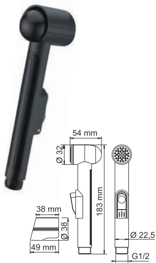
A081 Гигиеническая лейка с фиксатором. Покрытие черный Soft-touch.
