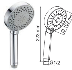
A032 Лейка для душа 5-функциональная с системой защиты от известковых отложений.
