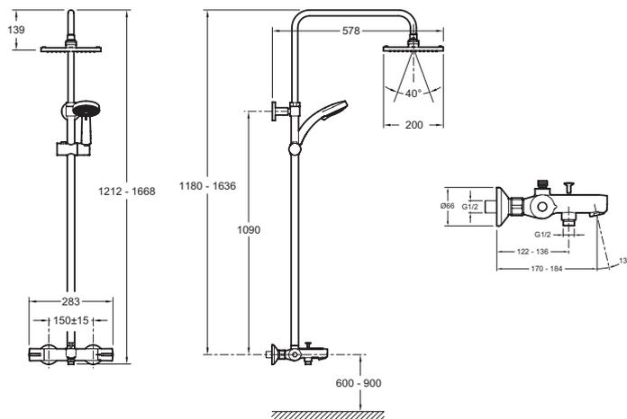
Descriptif CCTP : Colonne bain-douche thermostatique - douche de tête carrée. E78192. Collection : JULY. DIMENSIONS : 20 x 20 cm. TYPE D'INSTALLATION : Mural. NORMES ET RÉGLEMENTATIONS : ACS. AVEC OU SANS ROBINETTERIE : AVEC ROBINETTERIE. MITIGEUR : MITIGEUR THERMOSTATIQUE. FORME DE LA DOUCHE DE TÊTE : Carrée. DESIGN DE ROBINETTERIE DE BAIN : Carrée. BUTÉE DE SÉCURITÉ : 1. CLAPET ANTI-RETOUR : Yes. DÉBIT DOUCHETTE : 10 l/mn. CORPS TIÈDE : Yes.
