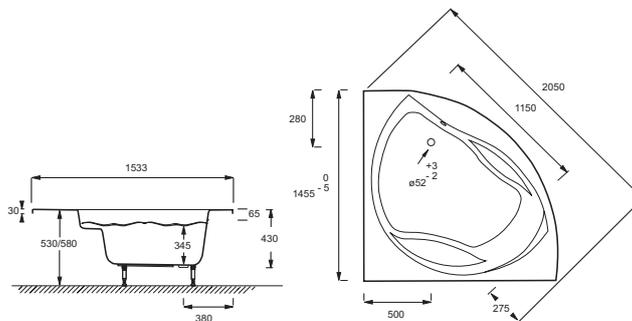
Спецификация продукта: Угловая ванна 145 x 145 см, для установки с каркасом. E6045RU. Коллекция: PRESQU'ILE. Размеры (см): 145 x 145 см. Вес: 36 кг. Материал: Акрил. Тип установки: Угловые. Объем: 265/195. Форма: Угловые. Диаметр слива: 5,2 см.
