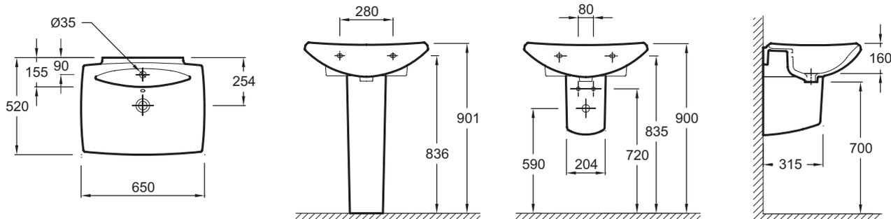
Спецификация продукта: Раковина 65 x 52 см с заглушкой для переливного отверстия. E1211. Коллекция: ESCALE. Размеры (см): 65 x 52 см. Вес: 17,6 кг. Разметка сверления отверстия для смесителя: С 1 отверстием для смесителя, два размечено. Крепежи: 2 шпильки для крепежа (в комплект не входит). Рекомендуемые смесители: Однорычажный Purist оригинальной конструкции.
